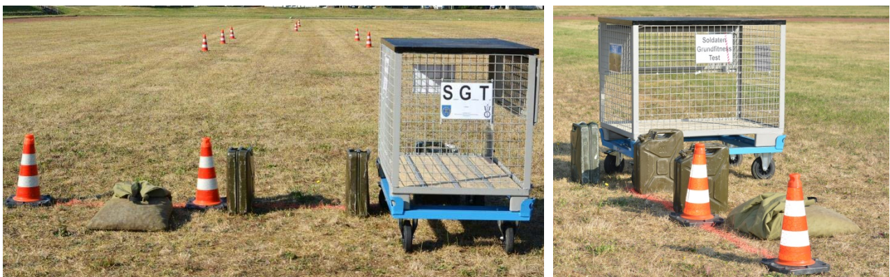
Abbildung 6. Detailaufbau des Start-/Zielbereichs des SGT-Parcours mit den exakten Positionen der Lasten, der Ablage und des Start-/Ziel-Pylons bzw. des Hilfs-Pylons;
