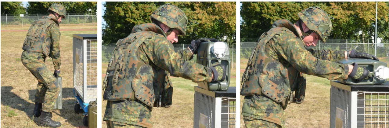
Abbildung 15. Heben und korrektes Absetzen des 24 kg Kanisters auf der Ablage (1,25 m); Startposition (links); Wichtig ist, dass der Kanister kurzzeitig mit seinem gesamten Gewicht auf der Ablage liegt. Dabei ist es egal, ob er hochkant (mittig) oder liegend (rechts) abgelegt wird. Als Richtlinie gilt: Der Kanister müsste nach dem Absetzen von selbst in der Position verbleiben. Nach dem Absetzen des Kanisters auf der Ablagefläche, wird er sofort wieder mit seinem gesamten Gewicht auf dem Boden abgestellt und erneut angehoben. Während des gesamten Arbeitsablaufes dürfen die Hände am Kanister verbleiben, ein Loslassen in den beiden Endpositionen ist nicht erforderlich.
